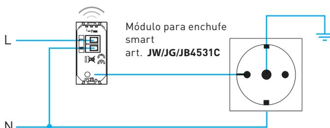
Para un correcto funcionamiento, conecte el conductor neutro a los dispositivos conectados.
